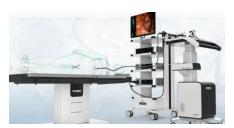
深セン羅伯医療科技株式会社が開発した消化管内視鏡手術器具制御装置(左側の画像をご参照)が国家薬品監督管理局の承認を受け、国内初の統合型消化内視鏡ロボットとなった。この装置は電気制御ユニット、駆動装置、操作ハンドルユニットで構成され、柔軟な機械アームと一回使用型内視
